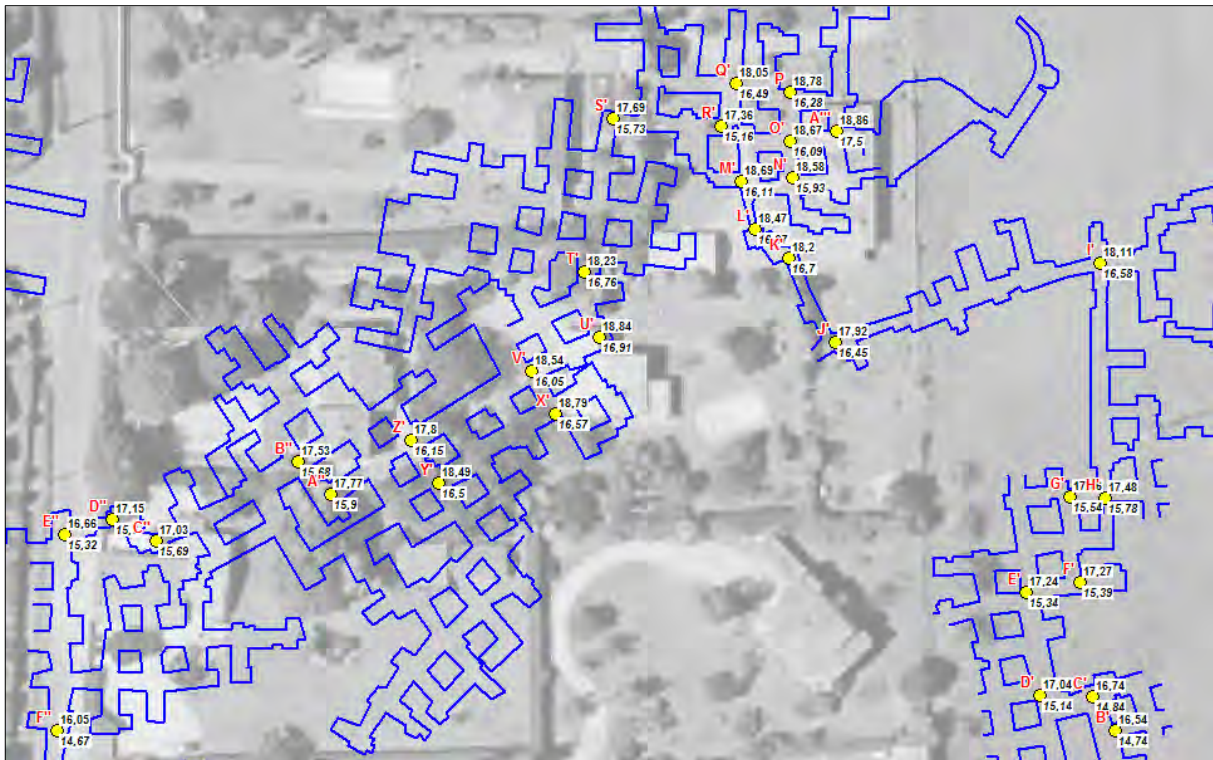
Fig. 54 : Extrait du relevé topographique de la carrière Brun (Niveau -3) – altitudes NGF du ciel et du sol [Source : Bureau des Carrières de Gironde / Ginger CEBTP]
