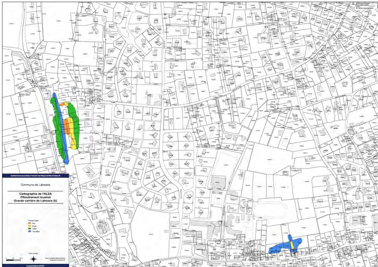
Fig. 28 : Cartographie de l'aléa mouvement de terrain généralisé [Source : EPRCF33]
