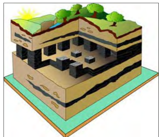
Fig. 31 : Exploitation en chambres et piliers abandonnés [Source : DREAL PACA]
